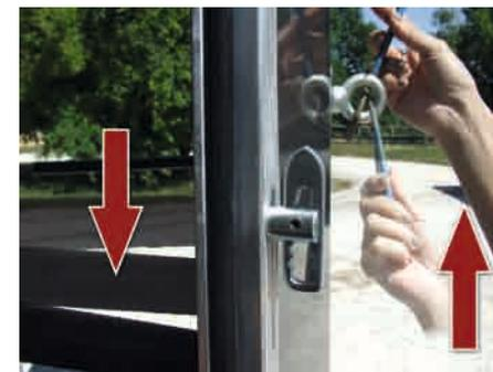
Barre de poitrail avec boucle de sécurité extérieure.
