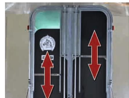
Volets coulissants intégrés dans les portes réglables en 3 positions d'aération.
