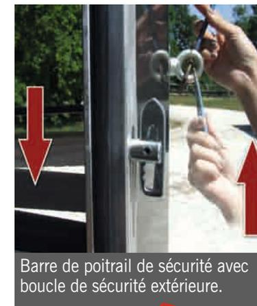
Barre de poitrail de sécurité avec boucle de sécurité extérieure.
